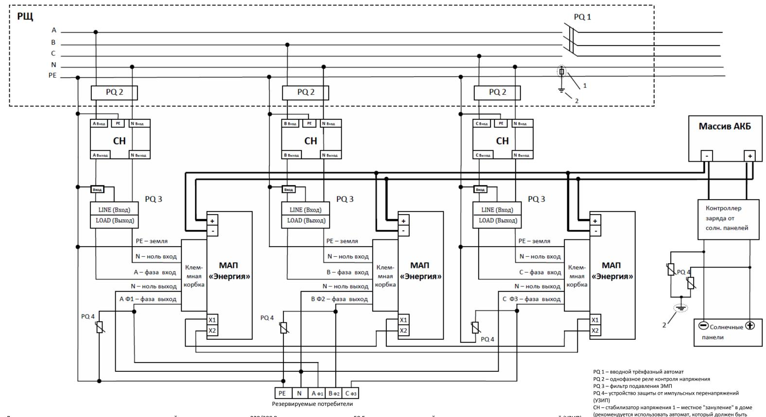
Для защиты от грозовых и коммутационных перенапряжений электроустановок в сетях 220/380 В переменного тока частоты 50 Гц устанавливается устройство защиты от импульсных перенапряжений (УЗИП), на схеме «PQ 4». Устанавливается на выход МАП, между фазой и землёй (минимум - металлический штырь, вбитый в землю на 1,5 м).
